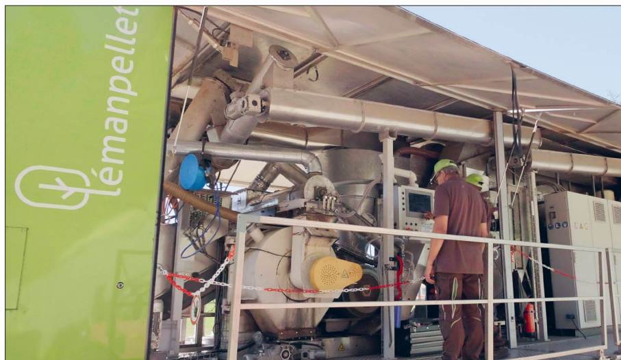
Une fois arrivé sur site, le camion de Lëmanpellet se transforme en usine de production.
