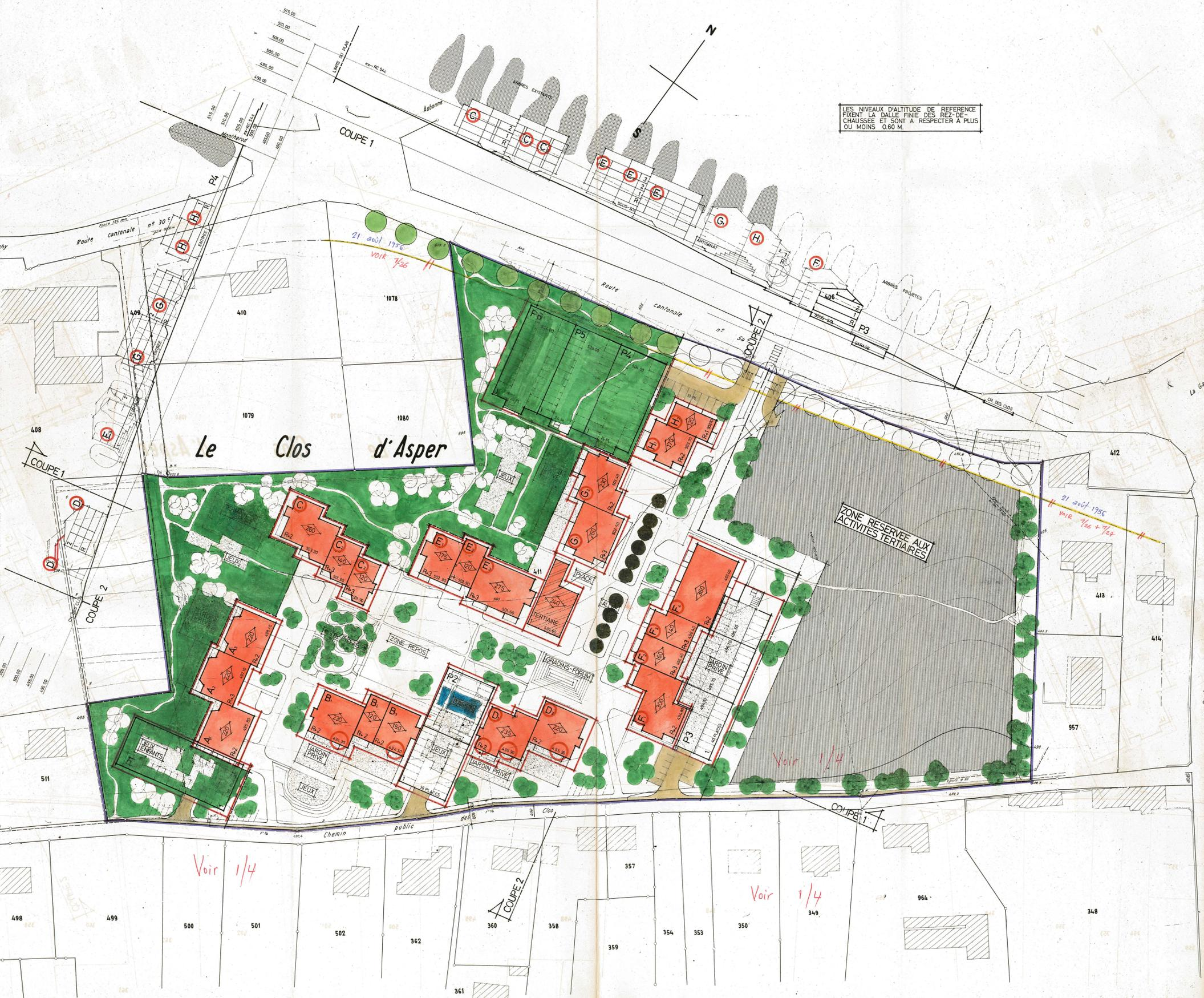
LES NIVEAUX D'ALTITUDE DE REFERENCE FIXENT LA DALLE FINIE DES REZ-DE-CHAUSSÉE ET SONT A RESPECTER A PLUS OU MOINS 0,60 M.
